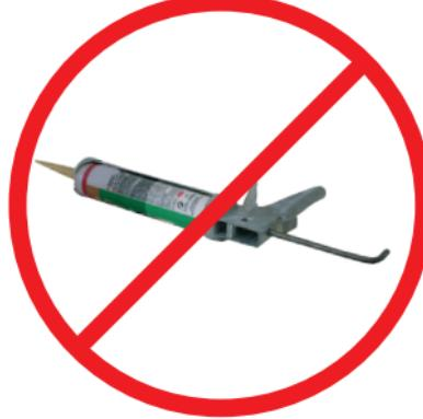
Der Inhalt dieser Kartusche ist eingetrocknet und nicht mehr zu verarbeiten. Solche Kartuschen sind getrennt zu entsorgen.
